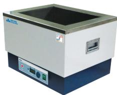
Бани масляные серии WHB предназначены для высокотемпературного нагрева образцов. Диапазон регулирования температуры - от комнатной температуры +5°C до 250°C. Необходимая температура рабочей камеры контролируется и поддерживается микропроцессорной системой на основе нечеткой логики. Сохранение температуры в рабочей камере обеспечивается с помощью теплоизоляции из керамического волокна.
