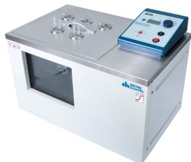
Вискозиметрические бани серии WVВ предназначены для исследований методом капиллярной вискозиметрии. Доступна одновременная установка пяти вискозиметров. В крышку бани устанавливаются держатели для капиллярных вискозиметров различных типов - Уббелоде, Канон-Фенске (прямой и обратный поток), Оствальд. Равномерность температуры в рабочей камере обеспечивается циркуляционным насосом с магнитным приводом, производительность насоса 30 л/мин.
