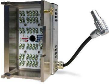
Светодиодный блок - опциональное оборудование для использования листовых кювет в пасмурные дни или для экспериментов с контролируемым освещением
