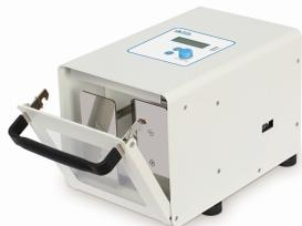
Гомогенизатор лопаточный Vle-400 от DAIHAN корпус которого выполнен из стали с порошковым покрытием имеют цифровой контроллер и низкий уровень шума благодаря инновационной системе рельсов. Используется в микробиологии, ветеринарии, клинической медицине, фармацевтики, молекулярной экстракции, а также в исследовании токсинов и анализа окружающей среды.
