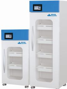
Фильтрующий шкаф от DAIHAN для хранения химических реагентов полностью полипропиленовый/поливинилхлоридный, камера из полипропилена с гибридным композитным фильтром, прозрачное окно из ПВХ. Полностью закрытая самоциркулирующая система, которая предотвращает попадание воздуха внутри шкафа в помещение и пары реагентов фильтруются через 4-слойный гибридный композитный фильтр. Идеально подходит для хранения кислотно-химических летучих органических соединений.
