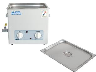
Аналоговый ультразвуковой очиститель "WUC-A" изготовлен из нержавеющей стали. Принцип работы основан на создании колебательных движений жидкости в камере, за счет чего обеспечивается очистка погруженных деталей. Предназначен для очистки объектов (колбы, пробирки, механические части двигателей, моторов, любых небольших металлических и пластиковых объектов) от механических загрязнений и удаление пузырьков воздуха из жидкости за счет применения ультразвука.
