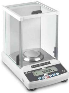
Высокопрофессиональные аналитические весы "АВТ", с внутренней автокалибровкой, многофункциональные (например, измерение плотности). Время стабилизации минимальное, ударопрочная конструкция.
