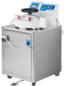
Серия средоварок АЕ-МР предназначена для подготовки, стерилизации и дозирования высококачественных питательных сред с превосходной воспроизводимостью от партии к партии. Благодаря эффективной системе нагрева и быстрому охлаждению сокращают время полного цикла приготовления среды. Безопасность Система блокировки дверей с датчиком положительного давления. Датчик открытия двери. Детектор уровня воды. Клапан безопасности. Термостат безопасности.
