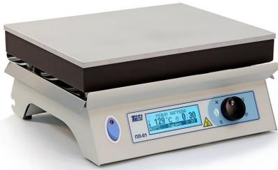
Плита нагревательная лабораторная для термообработки при контроле температуры и времени нагрева. Может быть снабжена дополнительной функцией задания скорости нагрева. Нагревательная платформа изготовлена из дюралюминия. Может быть укомплектована лотком для песчаной бани. Лоток для песчаной бани является съемным изделием. Дно лотка для песчаной бани выполнено из дюралюминия.
