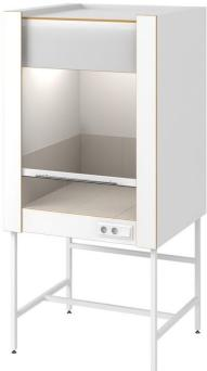
Шкаф вытяжной ШВмс, предназначен для установки муфельных печей, сушильных шкафов и другого термического оборудования. Конструктивно состоит из верхнего вытяжного бокса увеличенного размера и опорного цельносварного усиленного металлокаркаса на регулируемых опорах.
