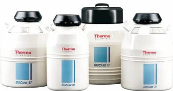
Криохранилища серии BioCane предназначены для безопасного длительного хранения в жидким азоте небольшого количества биологических образцов, размещенных в крио-соломинах или криопробирках различного объема (от 1,2 мл до 2,0 мл). Системы хранения представлены 6 моделями рабочего объема от 20,5 л до 71 л.
