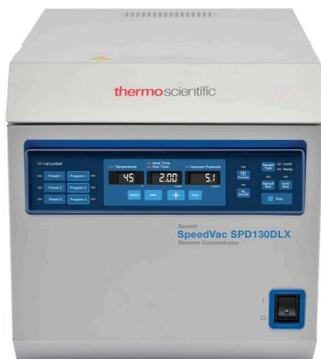
Thermo Scientific Savant SpeedVac SPD130DLX — вакуумный концентратор средней емкости с модульной конструкцией. Он совместим с большим количеством растворителей и обладает сопротивляемостью к трифторуксусной кислоте, ДМСО и другим агрессивным растворителям, которые применяются в комбинаторной химии.
