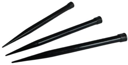
Качество наконечников является одним из определяющих факторов для надежной работы, минимального времени простоя и оптимальной производительности рабочей станции для автоматического дозирования жидкостей. Одноразовые наконечники выпускаются разного объема, с фильтром и без него, и выполнены из токопроводящего полипропилена, что позволяет автоматически определять уровень жидкости.
