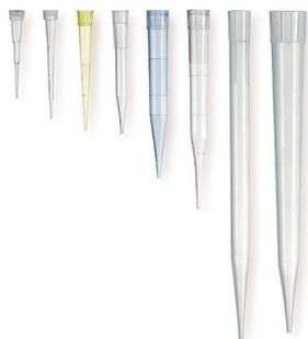
Наконечники для дозаторов предназначены для дозирования, разделения и перемешивания различных жидкостей и веществ, в том числе и в небольших объемах. Это один из самых востребованных расходных материалов, применяющийся в клинических и исследовательских лабораториях, лечебных учреждениях и т. д. Наконечники без фильтра идеально подходят для молекулярно-биологических исследований.
