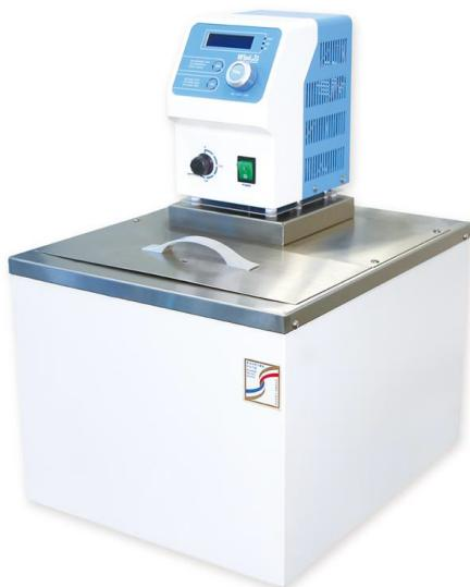
**Применение:** Циркуляционная ванна с нагревом MaXircu CH-12 предназначена для подачи подогретого теплоносителя в различные приборы и системы с целью поддержания во времени заданной температуры в замкнутом контуре в диапазоне от комн. +5 °C до 250 °C. Преимущественно используются в химических или физических лабораториях и небольших высокотехнологичных производствах. Ускорение протекания химических процессов за счет нагрева в органическом синтезе за счет циркуляции теплоносителя.
