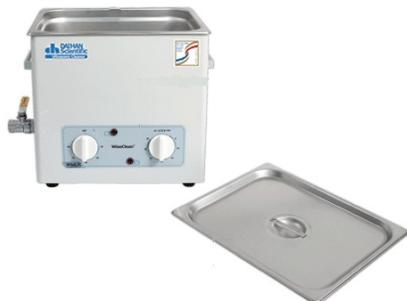
Применение: очистка объектов (колбы, пробирки, механические части двигателей, моторов, любых небольших металлических и пластиковых объектов) от механических загрязнений и удаление пузырьков воздуха из жидкости за счет применения ультразвука. Ультразвук представляет собой высокочастотные механические колебания частиц среды, которые распространяются в ней в виде попеременных сжатий и разрежений вещества. Частота ультразвуковых колебаний лежит в неслышном акустическом диапазоне (выше 16 кГц).
