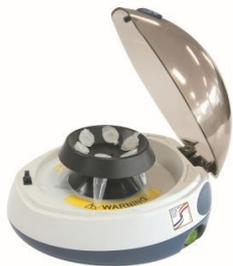
Применение: разделение раствора внутри центрифугируемой пробирки за счет центробежного ускорения, создаваемого при вращении пластикового сменного ротора. По окончании процесса происходит образование осадка внутри сосуда и растворителя сверху
