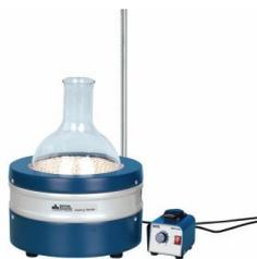
Колбонагреватель используется для нагрева жидких и твёрдых веществ, перегонки смесей, контроля фракционного состава, синтеза веществ, определения содержания воды по действующим стандартам, требующих нагрева колб. Нагрев жидкостей в круглодонных колбах объёмом 100 мл, с плавной регулировкой нагрева. Нагрев до 450 °С, аналоговое управление. Идеально подходит для всех типов круглых колб.
