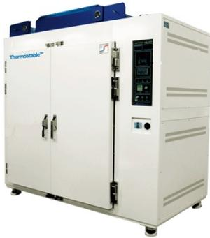
Промышленные сушильные шкафы с принудительной циркуляцией серии ThermoStable WOF предназначены для сушки электронных и полупроводниковых компонентов. Необходимая температура рабочей камеры контролируется и поддерживается цифровой системой с ПИД-регулированием. Безопасность работы обеспечивается встроенными системами защиты от перегрева и контроля сети электропитания (встроенные вольтметр и амперметр).
