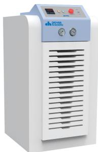
Охладители циркуляционные серии MaXircu Chi используют циркуляционный контур для охлаждения внешнего оборудования, например, при работе с ротационными испарителями. Диапазон регулирования температур – от -20 °С до +40 °С. Необходимая температура регулируется микропроцессорной системой с контролем по обратной связи. Распределение охлаждающей жидкости по контуру осуществляется применением циркуляционного насоса.
