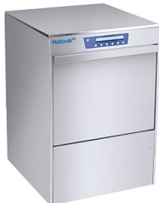
Лабораторные посудомоечные машины MaXscrub T1 предназначены для очистки посуды, используемой в биологических и химических исследованиях. Системы подачи водопроводной и дистиллированной воды и моющих средств – автоматические. Для различных типов мойки предусмотрены 6 предустановленных программ и 1 настраиваемая пользовательская программа. Двойные стенки корпуса машины для теплоизоляции и шумоизоляции.
